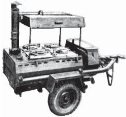
Рис. 4.6 б. Причіпна кухня КР-130, підготовлена до роботи.
