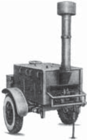
Рис. 4.6 а. Загальний вигляд кухні причіпної КР-125М.
