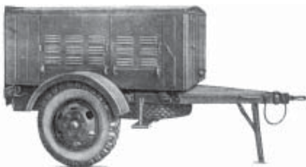
Рис. 4.5 а. Агрегат холодильний причіпний ПРХУ у похідному стані.
