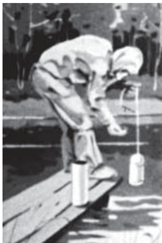
Рис. 3.4 а. Забирання проб води за допомогою батометра.
