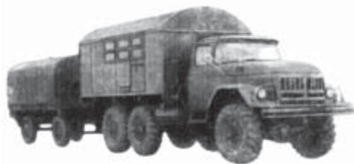
Рис. 3.15. Автомобільна фільтрувальна станція МАФС-3.
