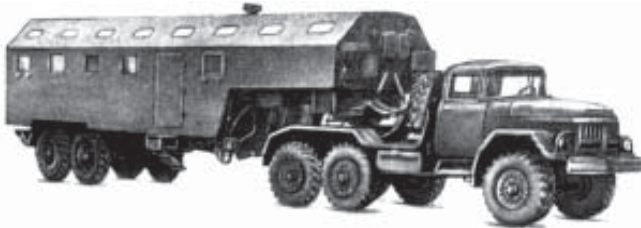
Рис. 4.2 а. Блок хлібопекарський автомобільний АХБ-2.5, підготовлений до руху.
