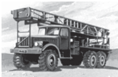
Рис. 3.17. Пересувна бурова установка.
