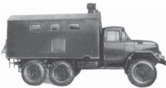
Рис. 4.7. Загальний вигляд похідної автомобільної кухні ПАК-200.
