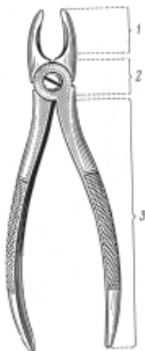
Мал. 18. Конструкція щипців: 1 – щічка; 2 – замок; 3 – ручка
